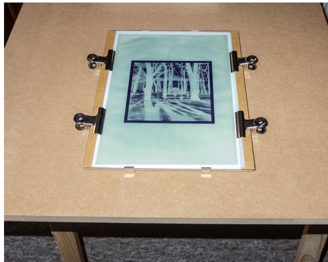
Chassis d'insolation (sous verre) feuille enduite et négatif sur transparent rétroprojecteur
